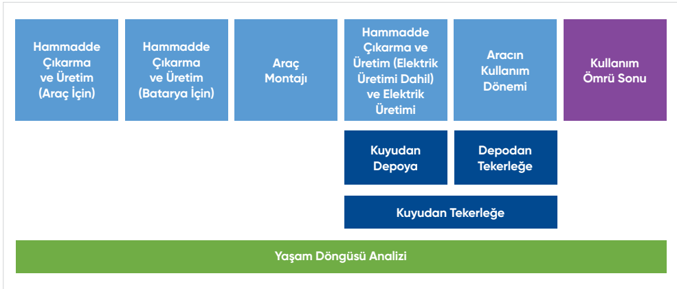
Şekil 2.13. Araçlar için LCA Aşamalarına Şematik Bakış
