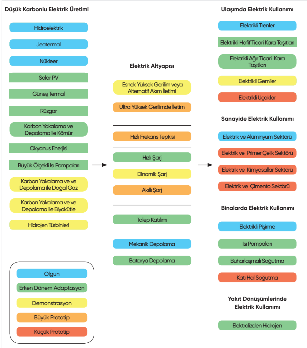
Şekil 3.37. Elektrik Sektöründe Teknoloji Hazırlık Seviyeleri (TRL )
